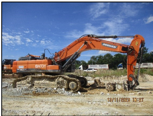
ภาพที่ 2.5 การนำ Hydraulic Breaker ติดหัวกัดมาใช้ในการทำเหมือง
