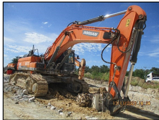
ภาพที่ 2.5 การนำ Hydraulic Breaker ติดหัวกัดมาใช้ในการทำเหมือง
